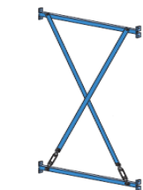
Diagonal-Kreuzverband mit Ständerverbindungen
