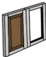
Rahmentür mit Massivholz-Kassettenfüllung
